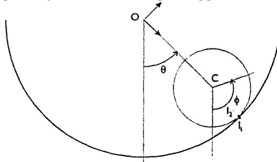
1. En écrivant la condition de roulement sans glissement, établir une relation entre  $R$ ,  $r$ ,  $\theta$  et  $\Phi$ .
