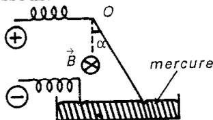
Le fil est placé dans un champ magnétique uniforme perpendiculaire au plan de figure.
