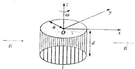
$N$  est très grand, et on néglige la résistance des disques. L'ensemble, plongé dans un champ magnétique uniforme  $\vec{B} = B\vec{e}_x$ , peut tourner autour de l'axe ( $Oz$ ). On note  $J$  le moment d'inertie du système par rapport à ( $Oz$ ).
